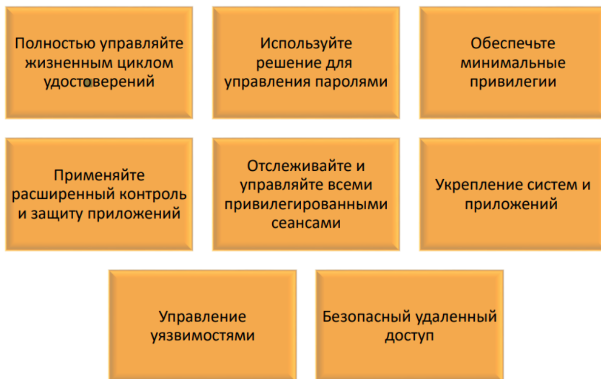
Рисунок 5 – Способы снижения риска повышения привилегий
