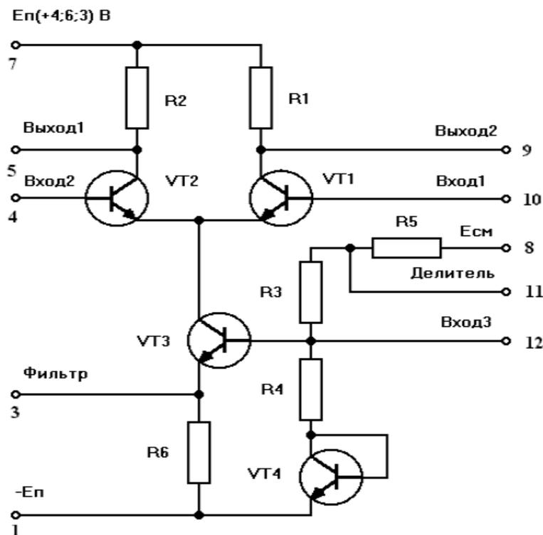
Рисунок 7.1 – Схема электрическая принципиальная ИС К122УД1А
