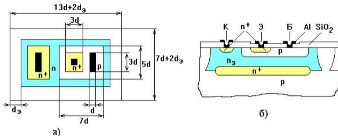
Рисунок 2.1 – Топология (а) и структура (б) интегрального транзистора:
