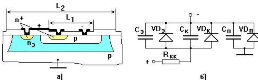
Рисунок 5.1 – Структура конденсатора на основе коллекторного и эмиттерного р-п переходов, включенных параллельно, (а) и его эквивалентная схема (б)
