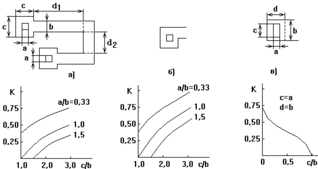
Рисунок 4.2 – Топология ДР зигзагообразной формы (а), несимметричной (б) и симметричной (в) контактных площадок и соответствующие зависимости коэффициента  $K$  от размеров этих площадок
