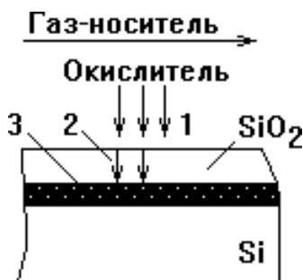
Рисунок 7.1 – Окисления кремния из газовой фазы: 1,2 – диффузия окислителя к поверхности пластины и границе раздела \text{SiO}_2 - \text{Si} , соответственно; 3 – зона реакции окислителя с кремнием
