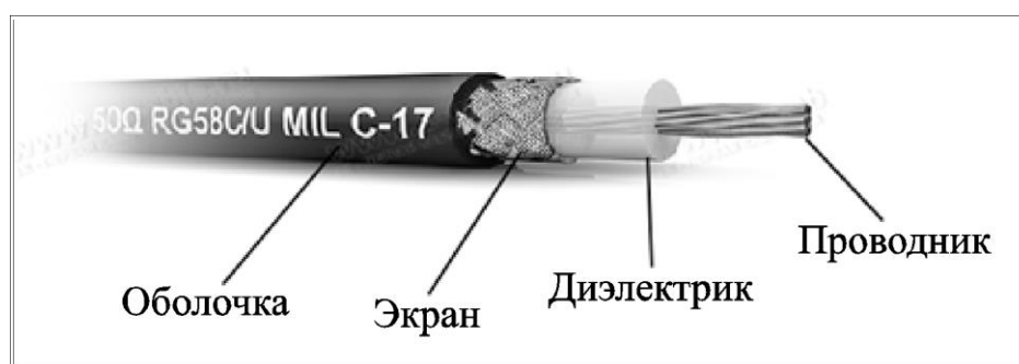
Рис. 5.11 – Коаксиальный кабель RG – 58C/U (Ethernet)
