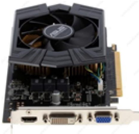
Рис. 3.25 – Разъёмы видеокарты Asus GeForce GT 740 (слева-направо: HDMI, DVI, D-SUB (VGA))
