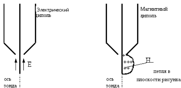
Рисунок 3.2 – Устройство электрического и магнитного зондов
