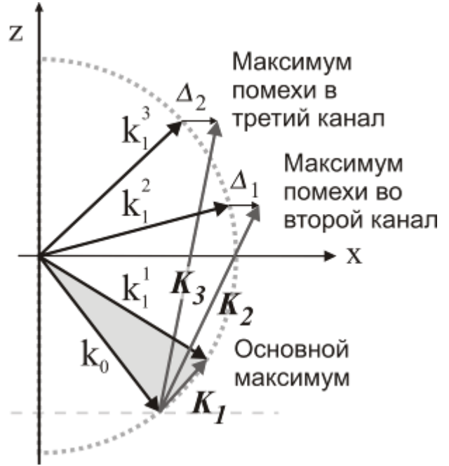
Рисунок 2.9 – векторная диаграмма считывания НГР
