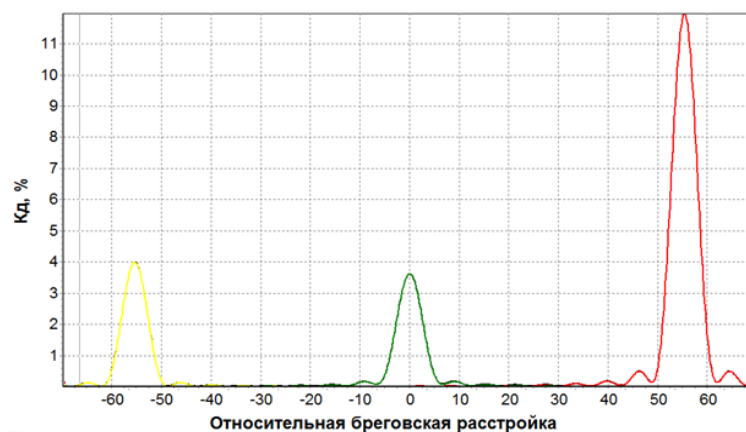
Рисунок 4.1 – Расчетное изменение интенсивности дифрагированного излучения I_d
