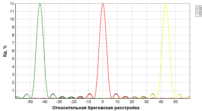
Рисунок 3.4 – Изменение дифракционной эффективности \eta_d решетки приотклонении от условий Брэгга с учетом автоматической оптимизации времени
