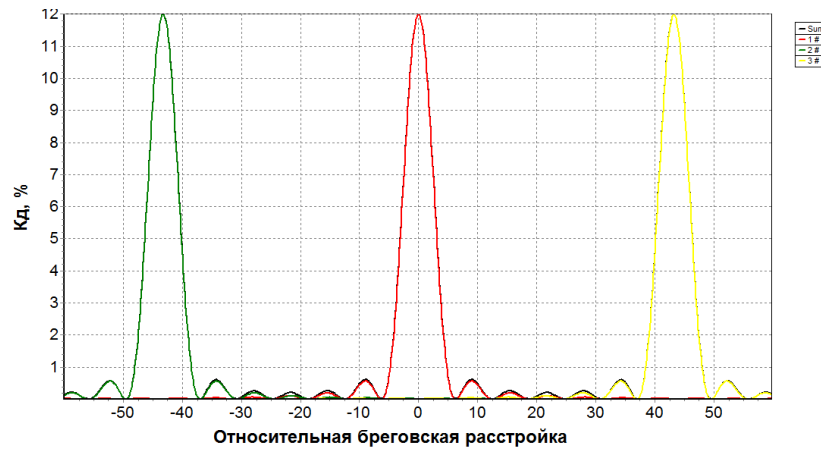
Рисунок 3.4 – Изменение дифракционной эффективности \eta_d решетки приотклонения от условий Брэгга с учетом автоматической оптимизации времени
