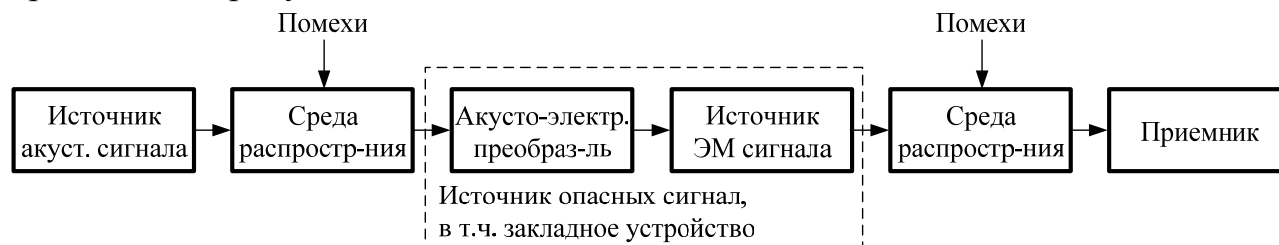
Рисунок 1.1 – Структурная схема акусто-радиоэлектронного канала утечки информации [1]
