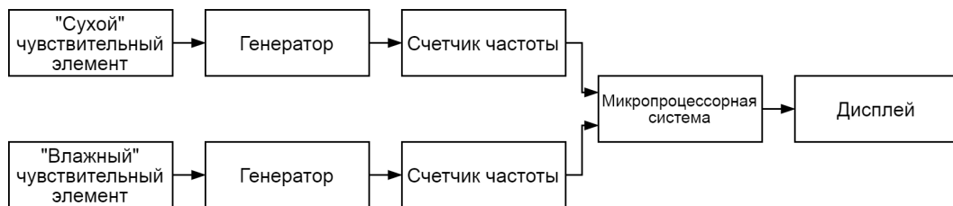
Рисунок 4.38 – Микропроцессорная система измерения относительной влажности
