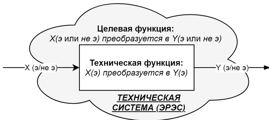
Рисунок 3.4 – Соотношение целевой (внешней) и технической (внутренней) функций системы
