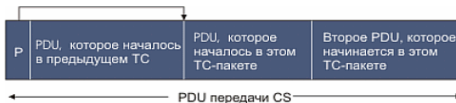
Рис. 9.6. Формат PDU при передаче по нисходящему каналу CS
