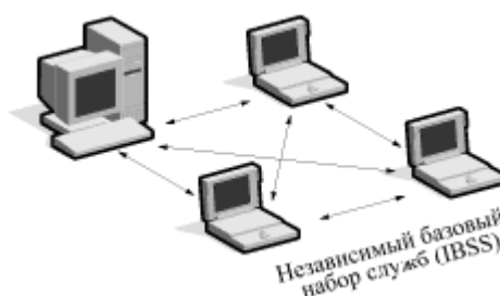
Рис. 7.4 Архитектура сети "Ad-hoc"
