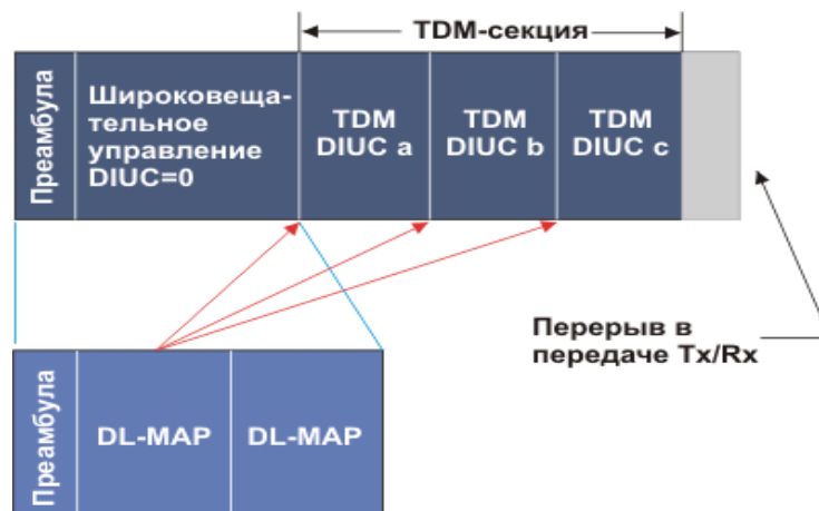
Рис. 9.17. Структура субкадра нисходящего канала для TDD
