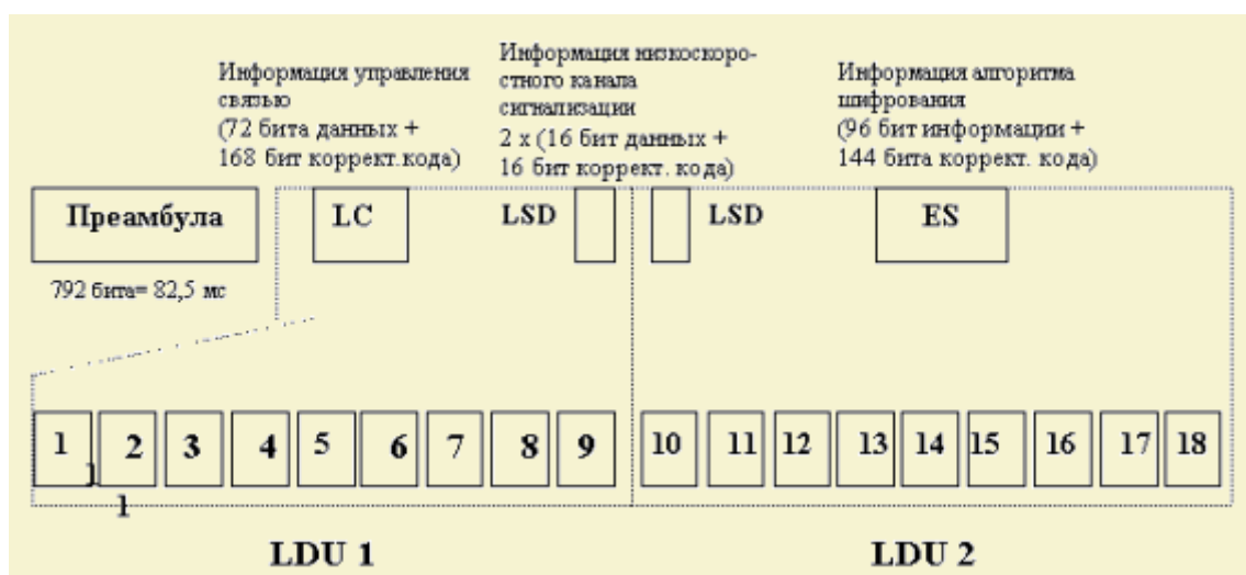
Рис. 2.14. Структура речевого суперкадра в стандарте APCO 25
