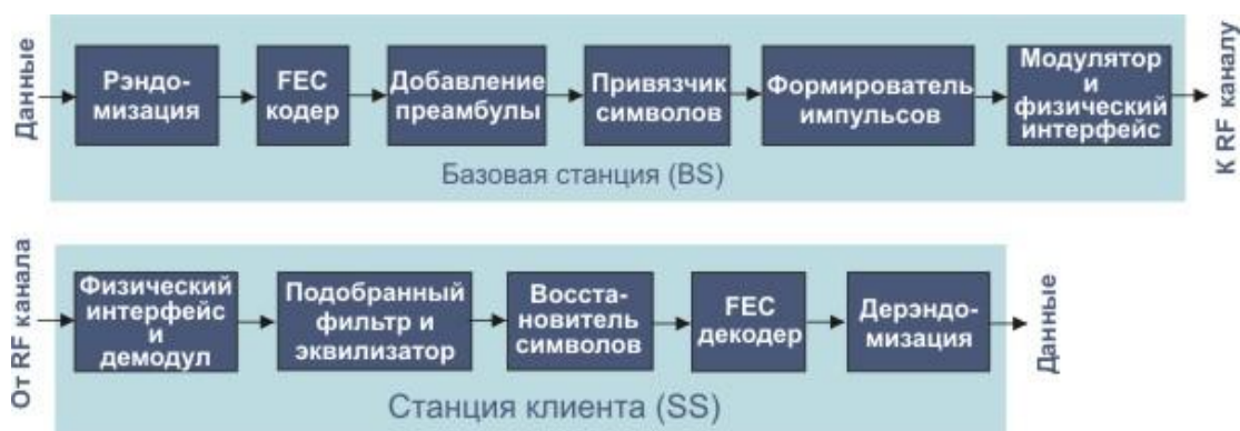
Рис. 9.7. Блок-схема подуровня PMD нисходящего канала
