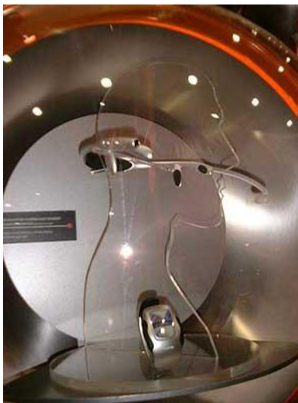
Рис. П4.3. Комплект оснащения киберпанка будущего - наушники, видеокамера, микрофон, внизу лежит коммуникатор в виде часов. Связь со станцией по протоколу Bluetooth на расстоянии до 100 метров
