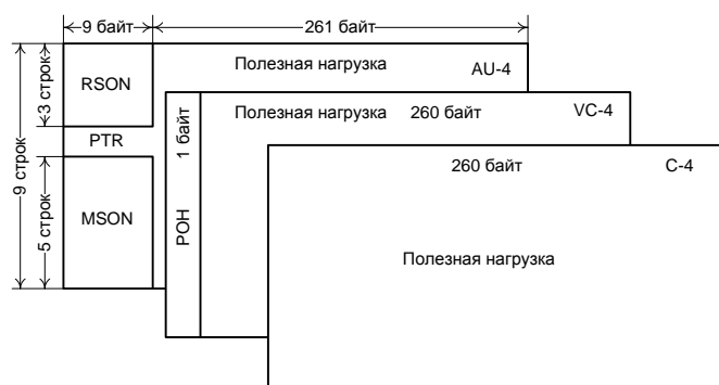
Рис. 1.2 – Структура модуля STM-1
