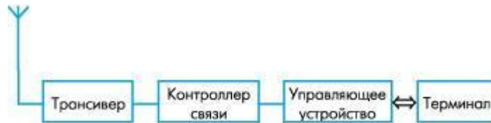
Рис. 8.9. Структура устройства Bluetooth
