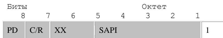
Рис. 3.15 Структура поля адреса LLC
