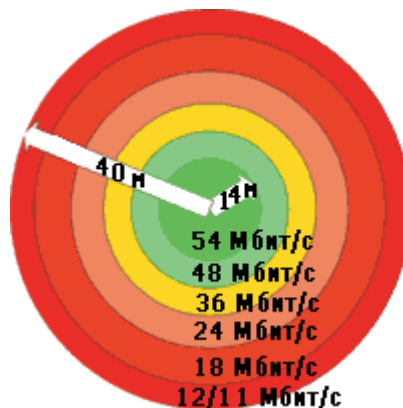
Рис. 7.2. Радиус действия в частотном диапазоне 2,4 ГГц (802.11g) при модуляции OFDM: скорость передачи данных 54 Мбит/с достигается лишь на расстоянии до 14 м
