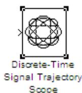
**Discrete-Time Signal Trajectory Scope** – блок отображения диаграммы переходов фазовых состояний сигнала из подраздела **Comm Sinks** раздела **Communication Blockset** библиотеки **Simulink** [6]. *Назначение:* отображение диаграммы рассеяния фазовых состояний за счет влияния полосы пропускания и помех тракта передачи. *Параметры блока:* Флажок **Show Plotting Properties** – показать графические установки; **Samples per Symbol** – шаг периода символа; **Offset (samples)** –
