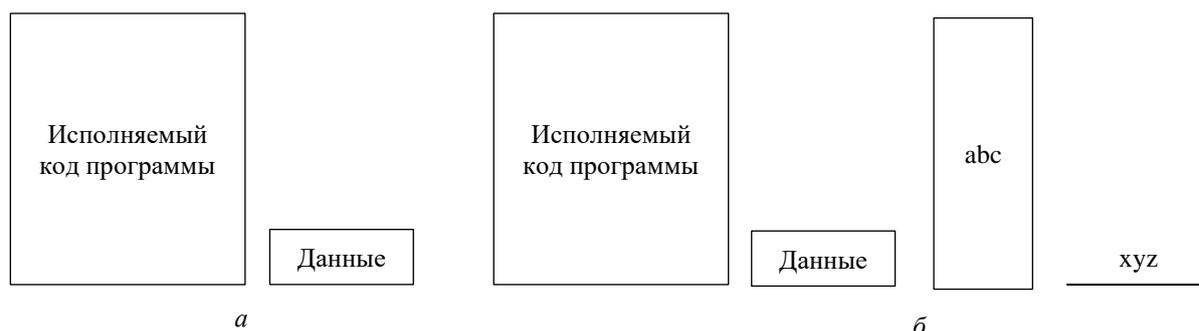
Рисунок 7.3 – Сегментированный процесс до отображения файла на адресное пространство (*а*); процесс после отображения существующего файла *abc* на один сегмент и создания нового сегмента для файла *xyz* (*б*)
