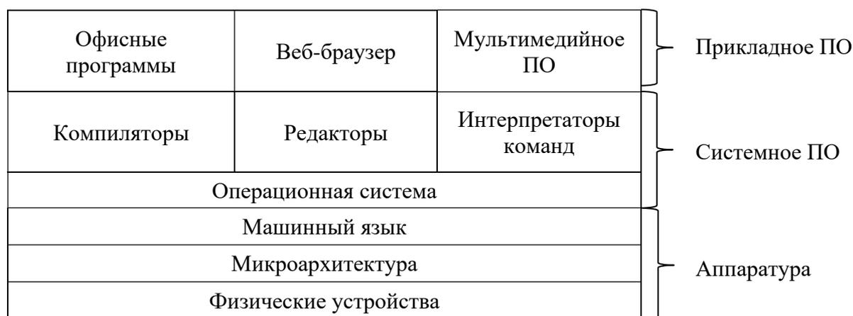
Рисунок 1.1 – Место операционной системы в структуре компьютера
