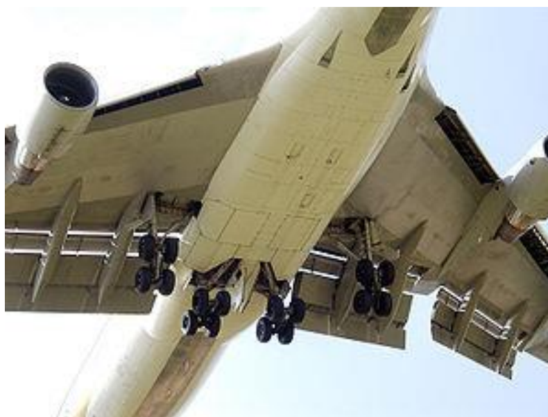
Рисунок 8.11 – Выпущенные закрылки и предкрылки
