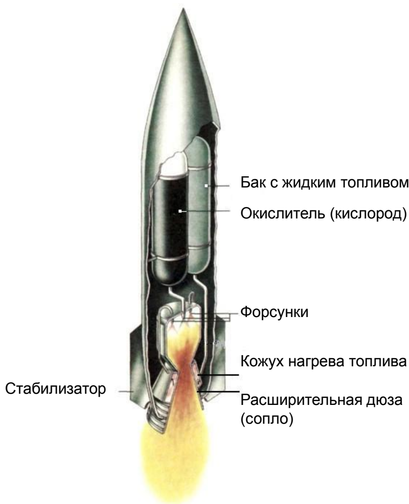
Рисунок 8.17 – Классическая конструкция одноступенчатой ракеты
