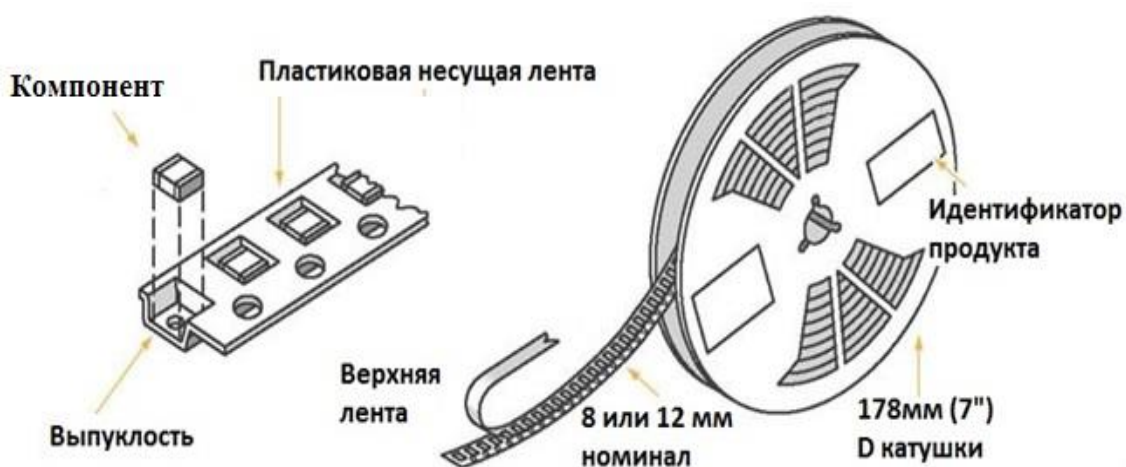
Рисунок 9.22 – Транспортная катушка SMD-компонентов
