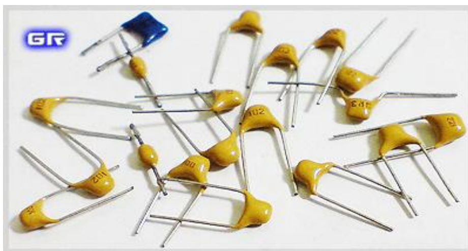
Рисунок 9.20 – Внешний вид керамических конденсаторов
