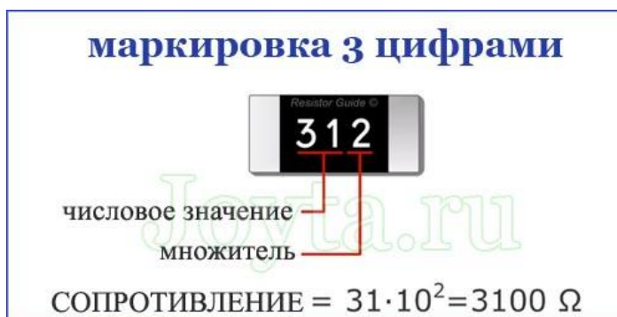
Рисунок 9.14 – Маркировка SMD-резисторов по трем цифрам
