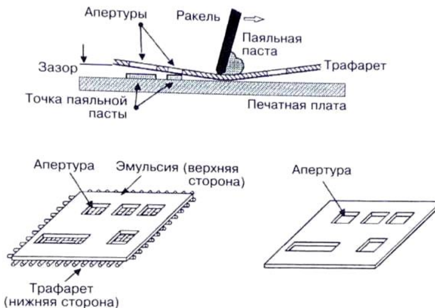
Рисунок 10.2 – Нанесение паяльной пасты с помощью трафарета
