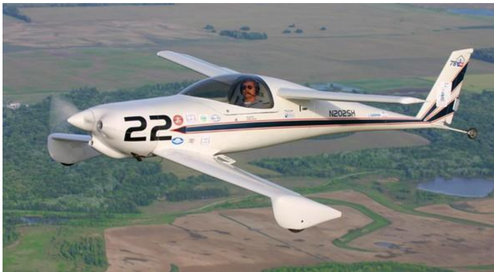
Рисунок 8.6 – Самолет, построенный по схеме «тандем»
