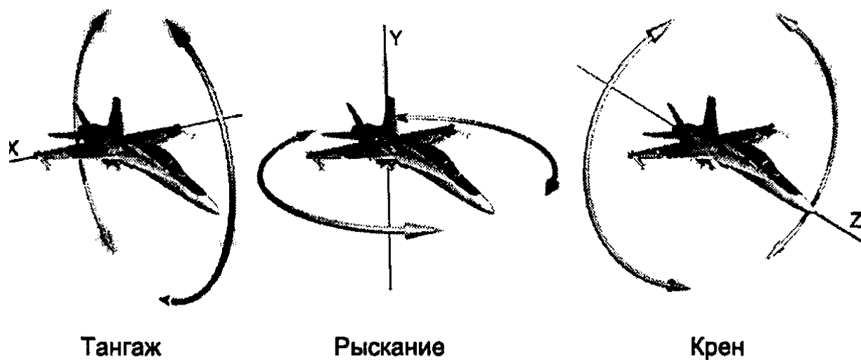
Рисунок 8.14 – Углы пространственной ориентации летательного аппарата
