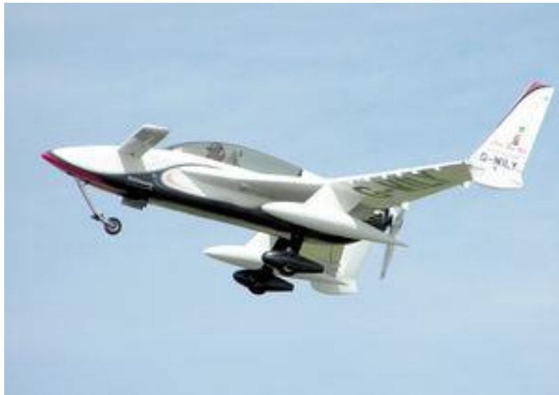
Рисунок 8.4 – Самолет, построенный по схеме «утка»
