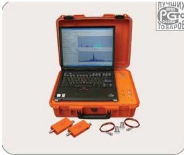
Рисунок 5.2 – Коррелометр виброакустический Т-2001 (течеискатель)
