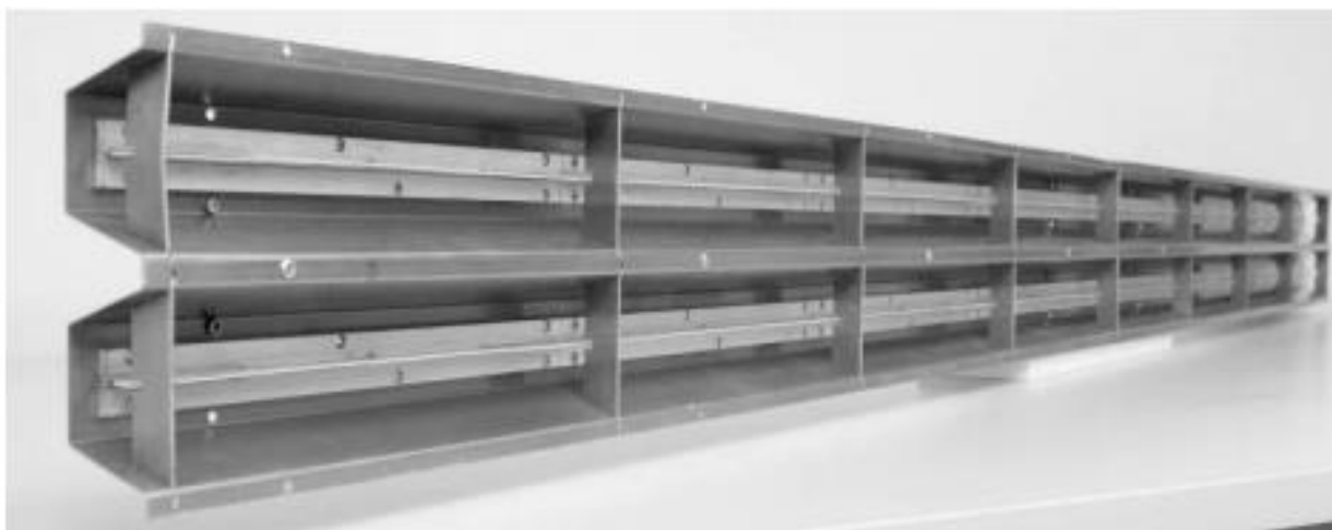
Рисунок 2.3 - Внешний вид приёмно-передающей антенны навигационной РЛС «Река»
