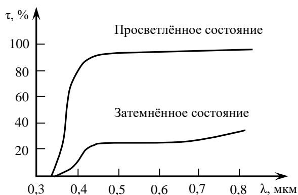
Рисунок 2.2 – Типовая спектральная характеристика коэффициента пропускания серого фотохромного стекла
