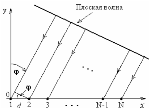
Рисунок 1.1 Геометрия N -линейной эквидистантной АР и плоской падающей волны
