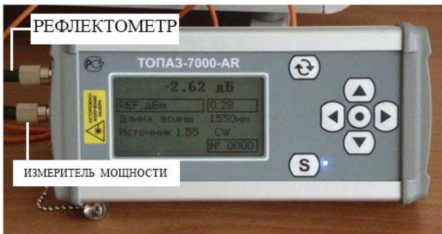
Рисунок 3.3 – Оптический тестер-рефлектометр «ТОПАЗ–7000–AR»
