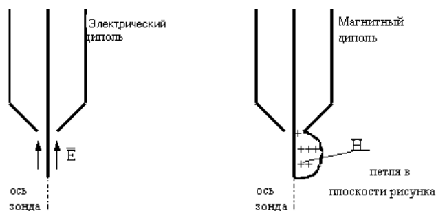
Рисунок 3.2 – Устройство электрического и магнитного зондов
