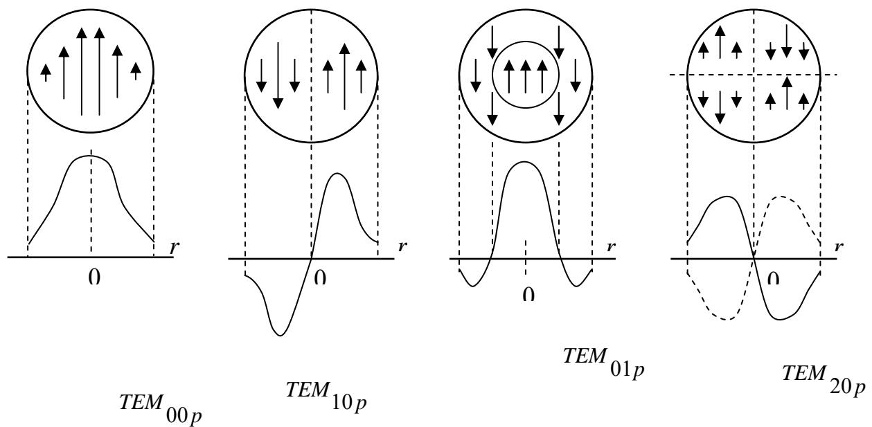
Рис.8.5 Распределения электрического поля для четырёх простейших угловых мод в плоскости  $z\text{-const}$  в цилиндрическом резонаторе.
