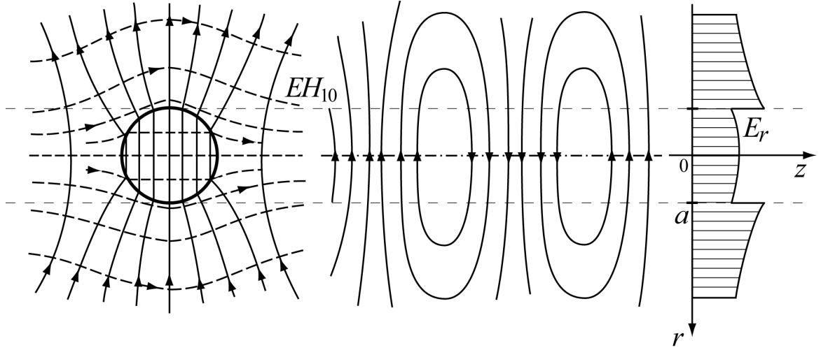
Рис. 7.4. Структура электромагнитного поля гибридной моды НЕ<sub>10</sub>
