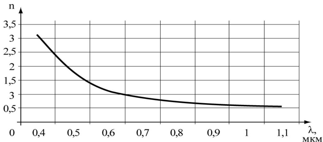
Рис.4.1. Зависимость коэффициента  $n$  от длины волны соединения TiO<sub>2</sub>.
