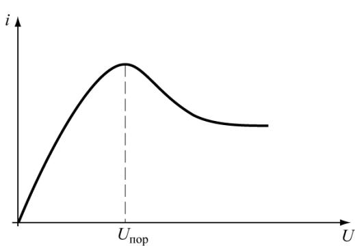
Рис. 5.1. Вольт амперная характеристика диода Ганна.
