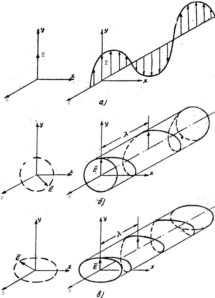
Рисунок 2.2. Виды поляризации электромагнитной волны: а) - линейная поляризация; б) - круговая поляризация; в) - эллиптическая поляризация .
