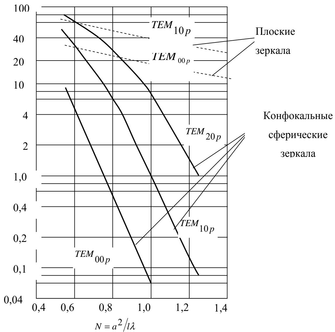
Рис. 8.7. Зависимость дифракционных потерь мощности  $p_{\text{диф}} \%$  (вертикальная ось) от  $N$  за один цикл движения волны (отражение от двух зеркал) для разных мод в конфокальном резонаторе.
