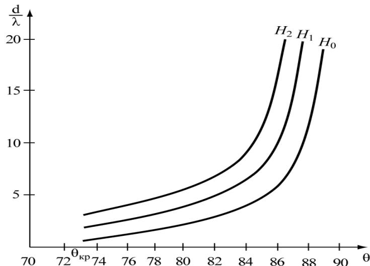
Рис. 6.3. Дисперсионные характеристики для волн типов  $H_0, H_1, H_2$
