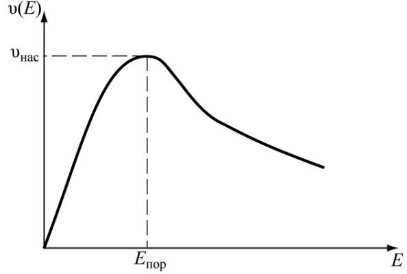
Рис. 5.4. Зависимость скорости носителей от напряженности поля  $E$  в образце диода.
