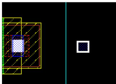
Рисунок 32 – Контактные площадки на пине транзистора
