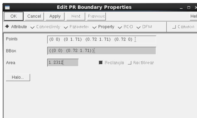
Рисунок 29 – Окно установки границы стандартной ячейки
