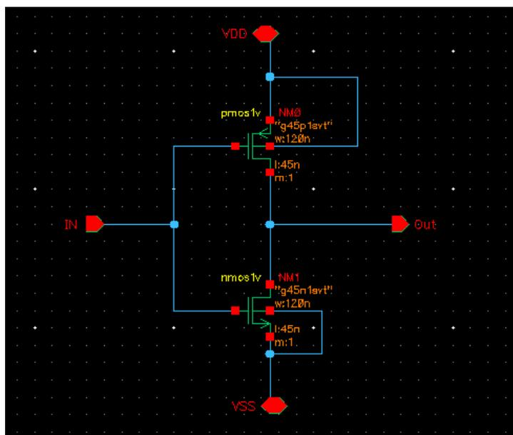
Рисунок 4 – Схема инвертора
