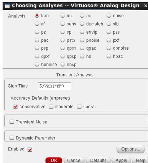
Рисунок 18 – Установка параметров временного анализа
