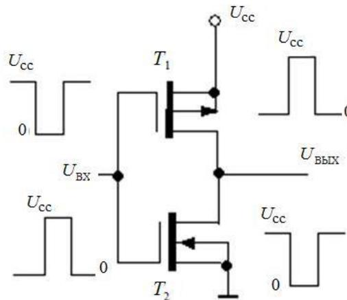
Рисунок 1 – Схема и временные диаграммы инвертора
