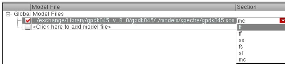
Рисунок 16 – Установка варианта модели tt
