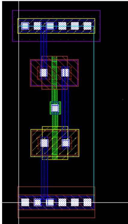
Рисунок 33 – Топология инвертора
