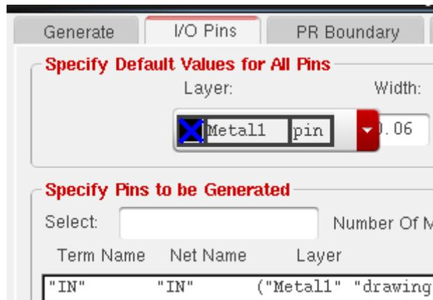
Рисунок 25 – Выбор слоя металлизации для контактов стандартной ячейки
