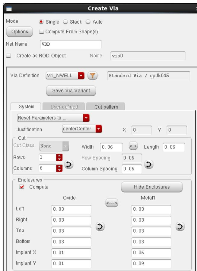
Рисунок 30 – Настройка линейки контактных площадок (шины питания)
