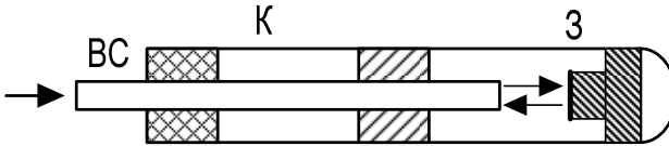
Рис. 5.12. Схема измерителя температуры на основе встроенного ИФП
