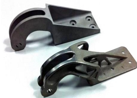
*Рисунок 2.28. Изделия, полученные по технологии прямого лазерного спекания*
