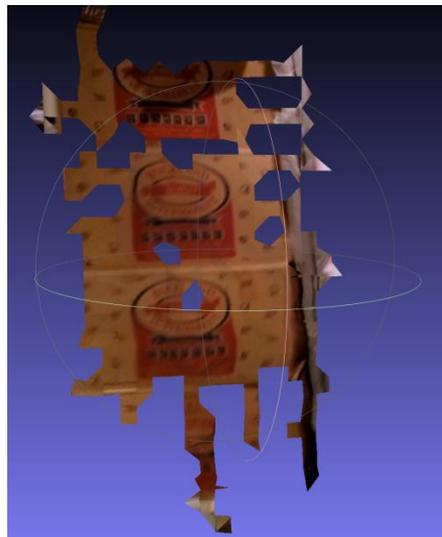
Рисунок 6.2 Пример модели с отверстием
