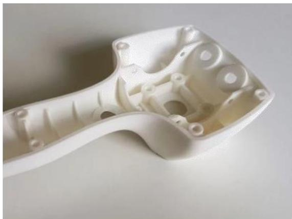
Прототип, созданный на SLS-принтере ONSINT
