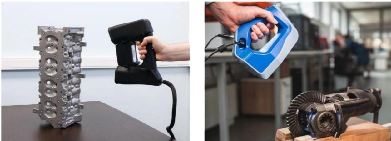
*Рисунок 5.29 3D сканеры для промышленного производства*
