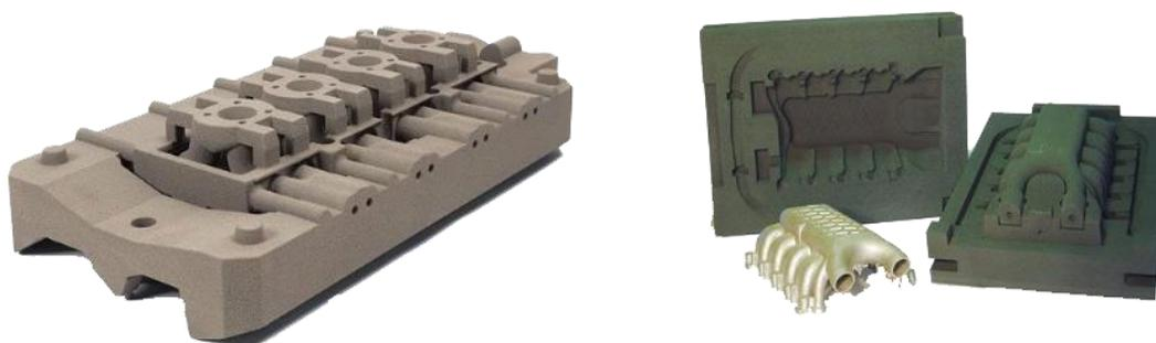
*Рисунок 5.14 Литейные формы для производства металлических изделий*
