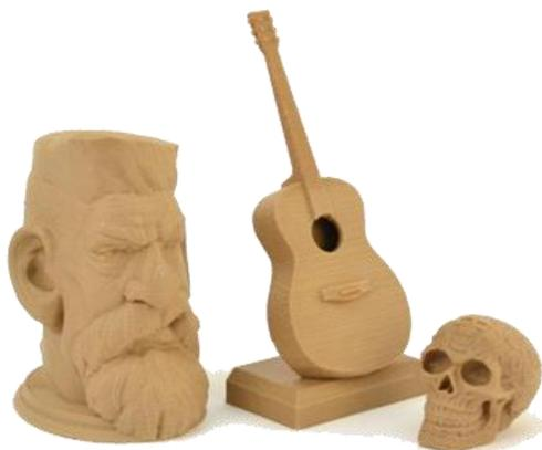
Рис. 2.19. Модели, полученные из филамента *BambooFill*
