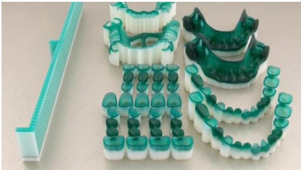
Рисунок 2.23. Изделия, полученные с помощью технологии многоструйного моделирования
