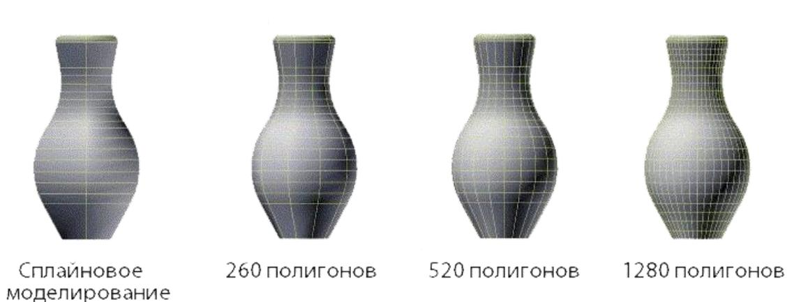
*Рисунок 4.5 Сравнение объектов при сплайновом и полигональном моделировании*
