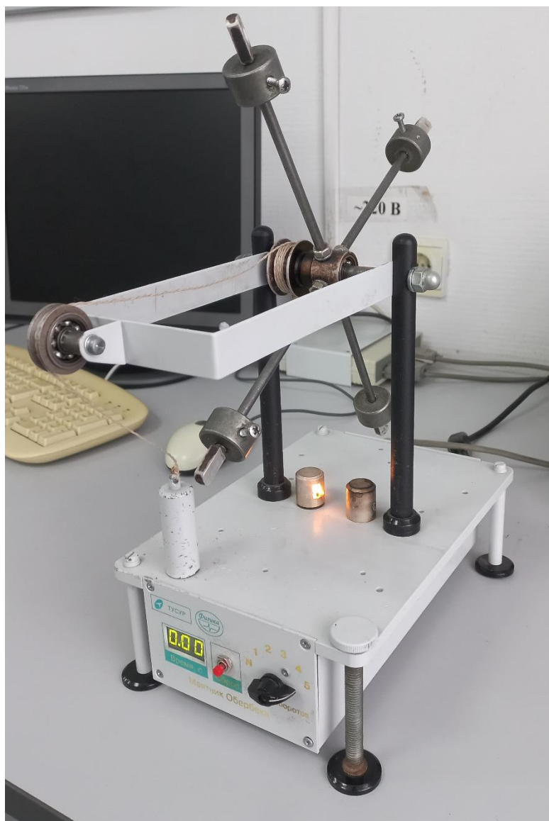
Рисунок 3.2 – Экспериментальная установка «Маятник Обербека»
