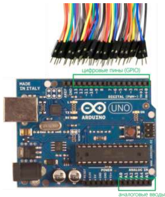
Рисунок 4 – Выводы микроконтроллера на плате Arduino
