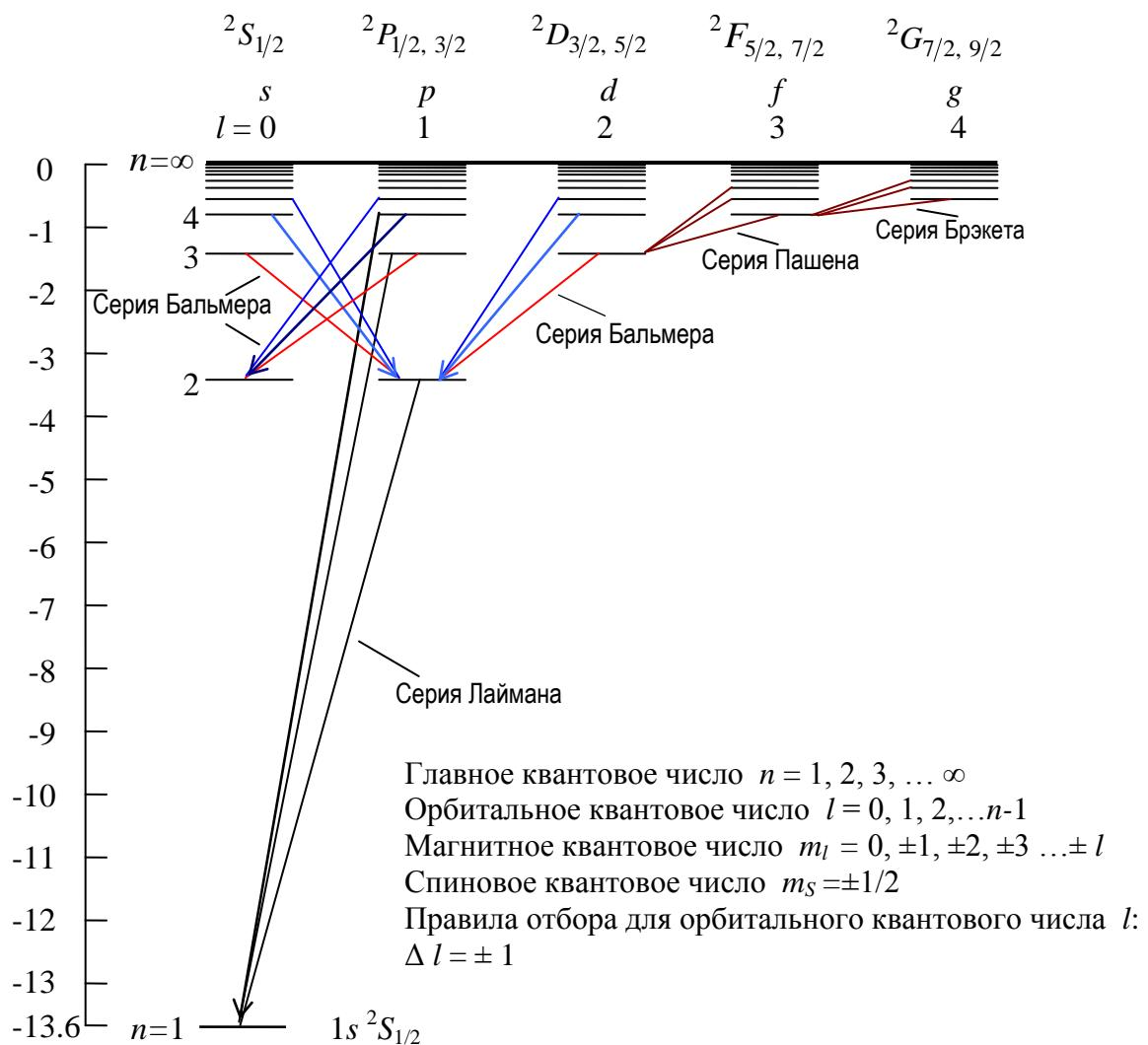
Рисунок 1.1 — Схема энергетических уровней атома водорода
