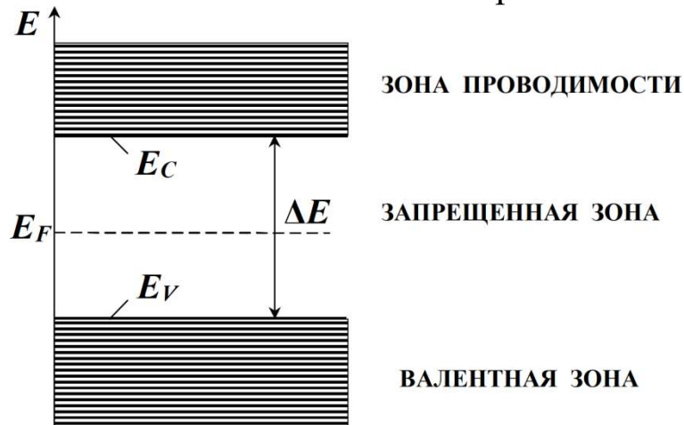
Рисунок 1.1 – Зонная диаграмма собственного полупроводника:
