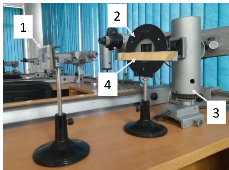
Рисунок 3.1 – Экспериментальная установка: 1 – дифракционная решетка; 2 – коллиматор; 3 – ртутная лампа; 4 – линейка с миллиметровой шкалой
