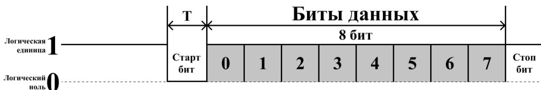
Рисунок 7.1 – Представление пакета данных для передачи по последовательному интерфейсу
