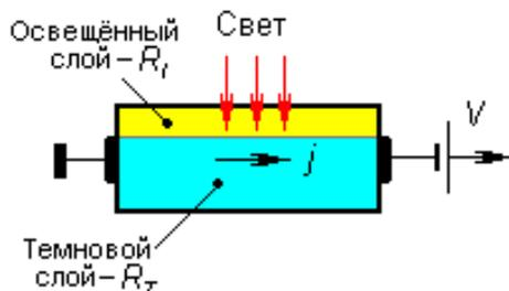
Рисунок 2 - Освещенная и темновая области фоторезистора
