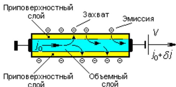
Рисунок 3 – Механизм возникновения избыточного шума
