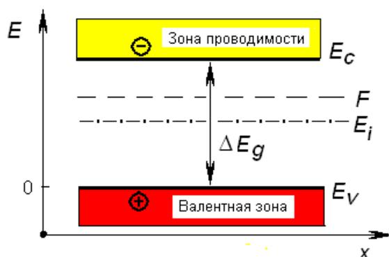
Рисунок 1 - Энергетическая диаграмма полупроводника; зоны разрешённых и запрещённых энергий
