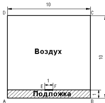
Рисунок 1.24 – Микрополосковая линия передачи
