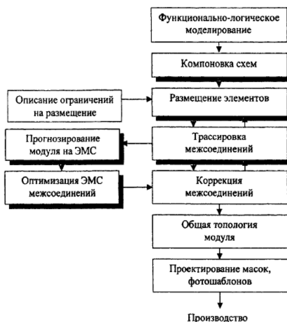
Рисунок 1.2 – Процесс проектирования электронного средства с учетом ЭМС
