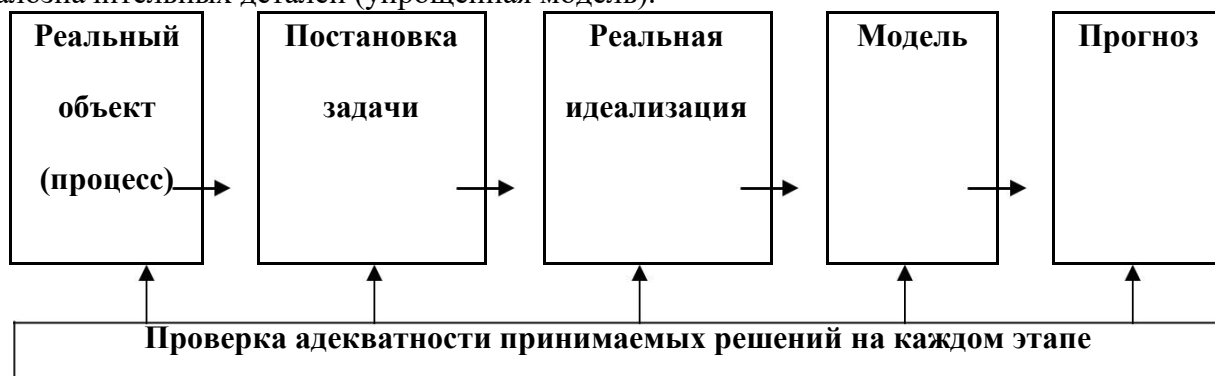
Рисунок 1.1 – Структура алгоритма моделирования ЭМС ТС
