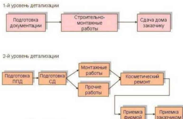
Рис.6. Пример сетевой модели проекта «Капитальный ремонт дома»
