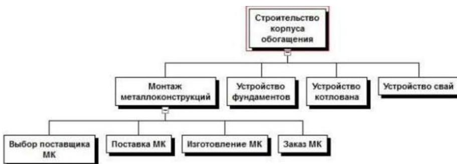
Рис. 5. Пример структуры разбиения работ проекта «Строительство корпуса»
