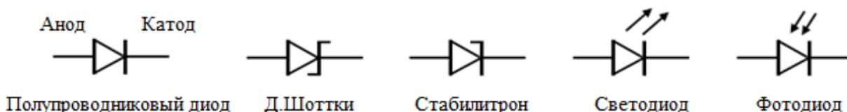
Рис. 1.1 – Условные графические обозначения некоторых типов диодов
