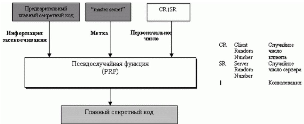
Рисунок 1.19 – Генерация главного секретного кода
