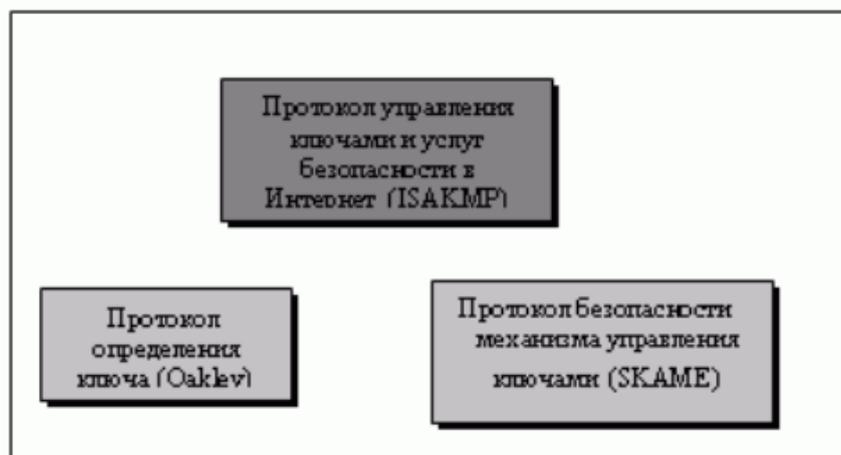
Рисунок 1.42 – Компоненты протокола управления ключами в Интернете
