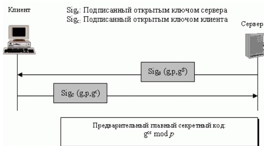
Рисунок 1.5 – Кратковременный протокол Диффи-Хеллмана смены ключей
