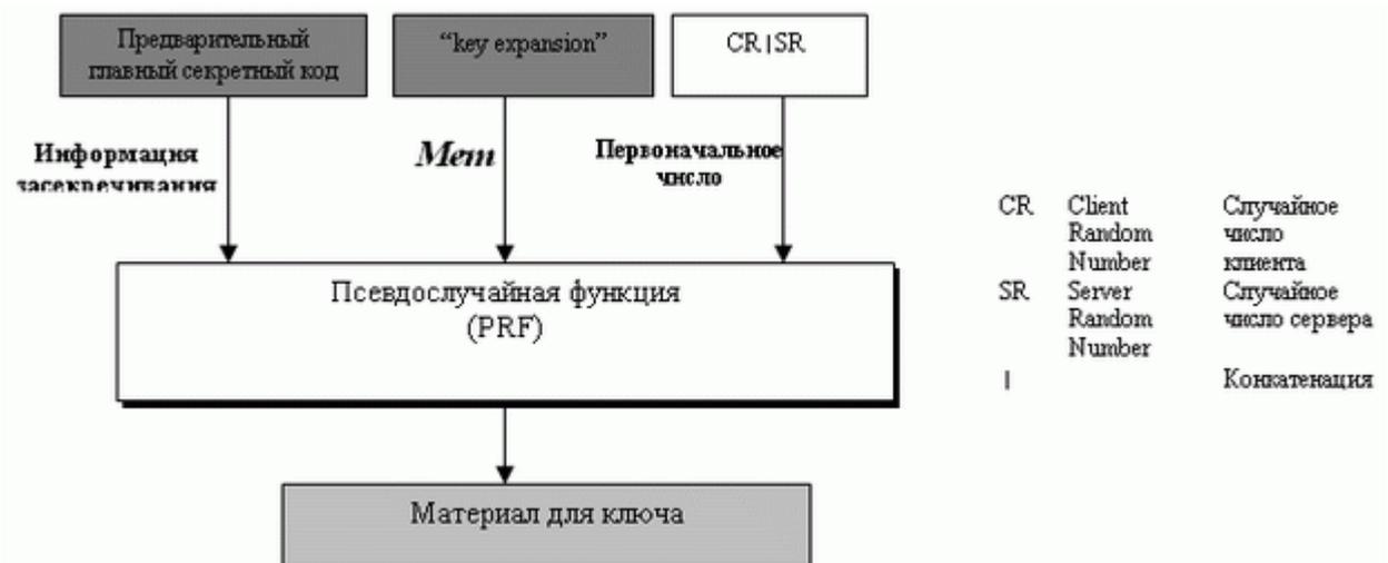
Рисунок 1.20 – Генерация материала для ключа
