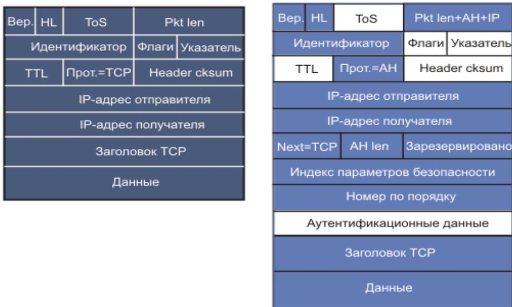
Рисунок 1.33 – Преобразование форматов в транспортном режиме АН IPSec
