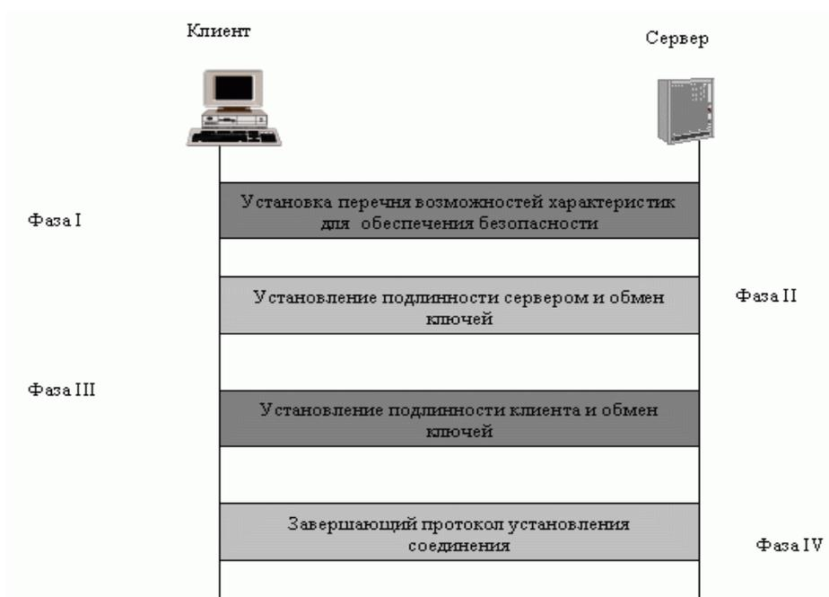
Рисунок 1.12 – Протокол установления соединения
