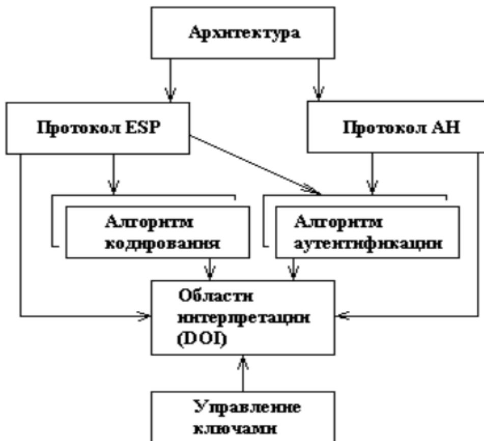
Рисунок 1.23 – Архитектура IPsec
