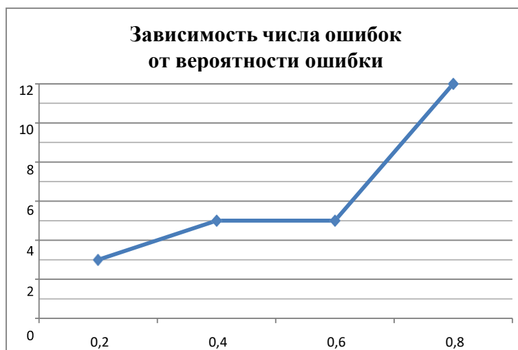
Рис. 3.18. График зависимости числа ошибок (OY) от вероятности ошибки (OX) для кода Хэмминга (7,4)
