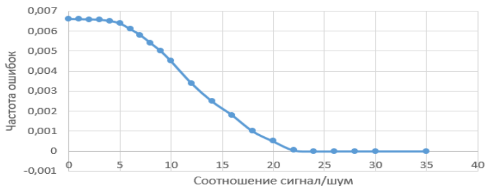
Рис. 4.48. Зависимость частоты ошибок от отношения сигнал/шум
