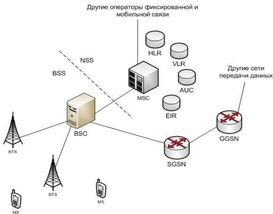
Рис. 5.61. Структура сети стандарта 2G (GSM)
