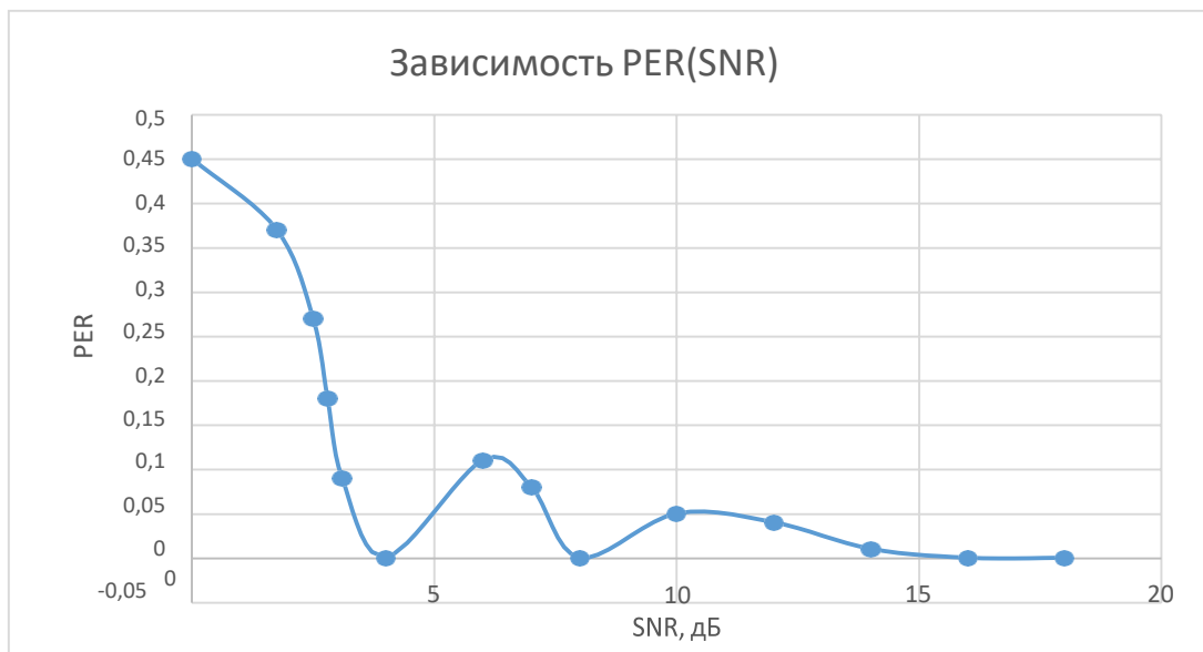
Рис. 5.24. Зависимость PER от SNR при работе адаптивного алгоритма
