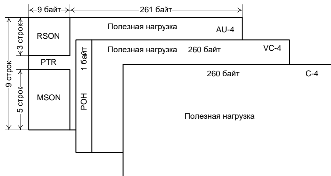
Рис. 6.2 – Структура модуля STM-1
