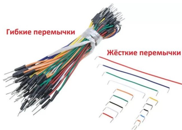
Рисунок 15. Виды перемычек для безопасных макетных плат
