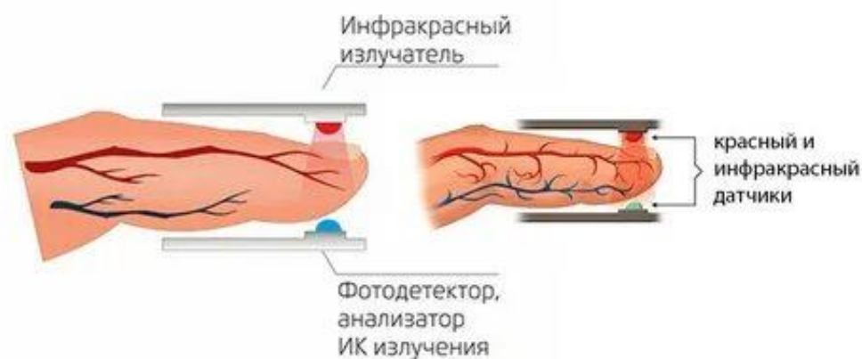
Рисунок 1 – Принцип работы пульсоксиметра
