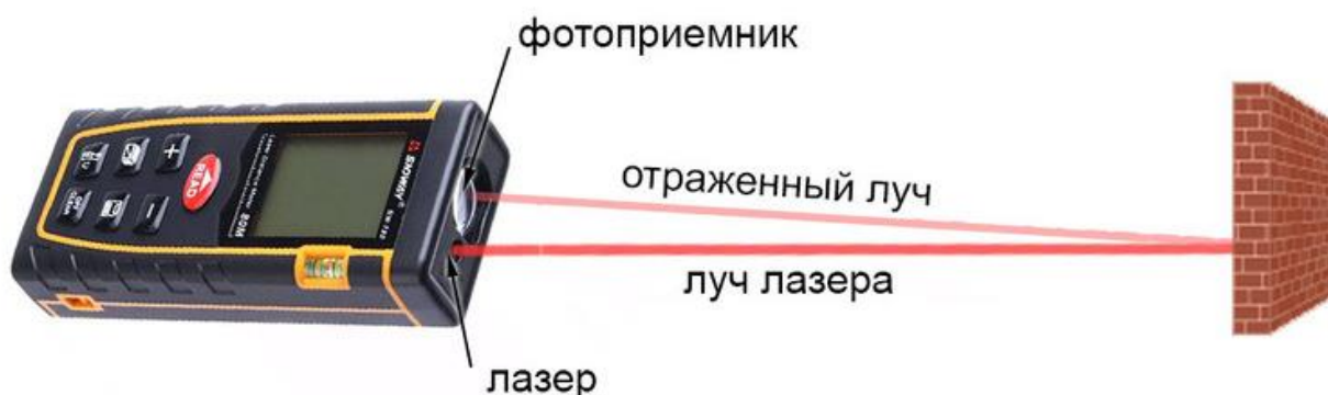
Рисунок 2 – Принцип работы лазерного дальномера
