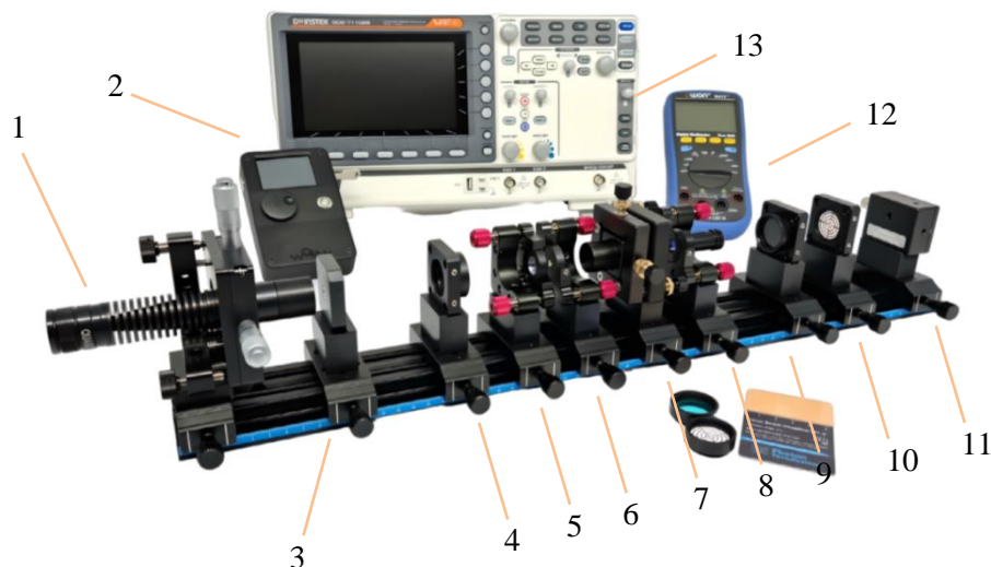
Рисунок 2.1 – Лабораторный стенд для исследования генерации второй гармоники
