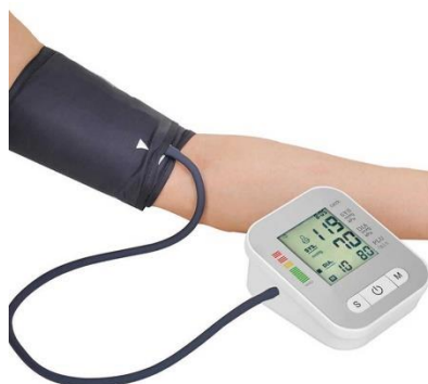
Рисунок 2.3 – Измерение артериального давления электронным тонометром по методу Н.С. Короткова
