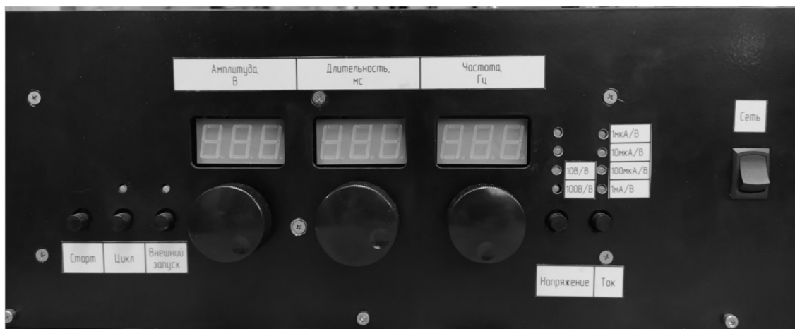
Рисунок 3.7 – Внешний вид блока питания и регистрации двойного зонда
