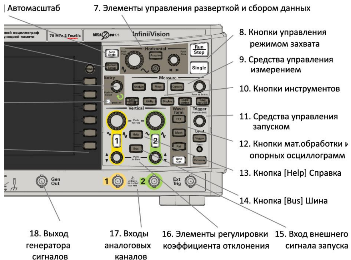
Рис. А.2 – Органы управления осциллографом
