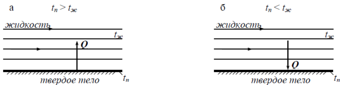
Рисунок 4.3 – Теплоотдача от поверхности тела к жидкости (а) и от жидкости к поверхности твердого тела (б)
