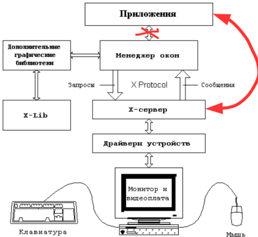
Рисунок 1.8 — Общая архитектура X Window System
