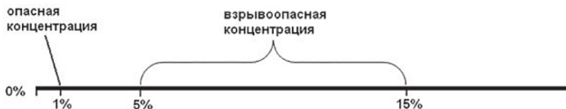
Рисунок 1.3 – Опасная и взрывоопасная концентрация природного газа
