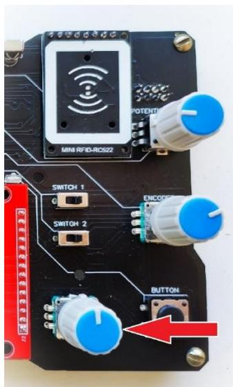
Рисунок 3.2 – Энкодер, используемой для навигации
