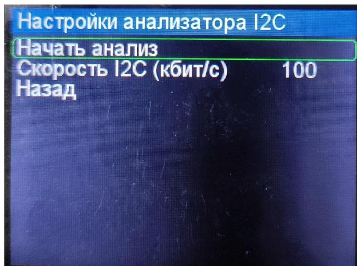
Рисунок 2.1 – Настройка логического анализатора для работы с I2C
