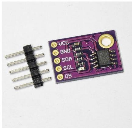
Рисунок 1.4 – Внешний вид модуля датчика температуры LM75A
