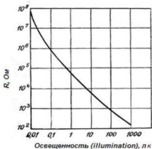
Рисунок 1.3 – График изменения сопротивления в зависимости от освещенности
