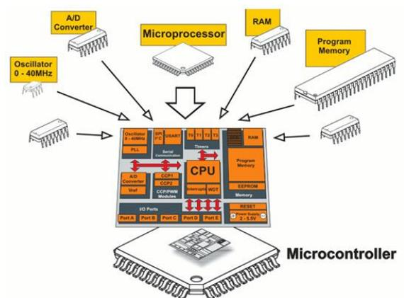
Рисунок 1.2 – Вид микроконтроллера
