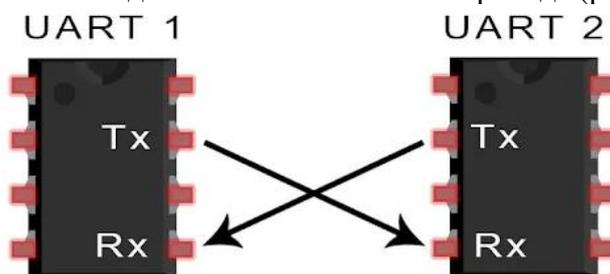
Двунаправленная передача данных интерфейса UART
