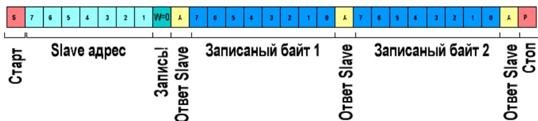
Рисунок 1.6 – Графическое представление следования пакетов данных от ведущего к ведомому в I2C
