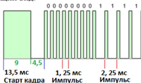
Рисунок 1.1 – Внешний вид логических уровней протокола NEC
