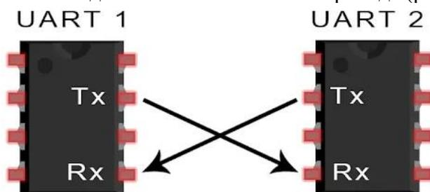
Двунаправленная передача данных интерфейса UART
