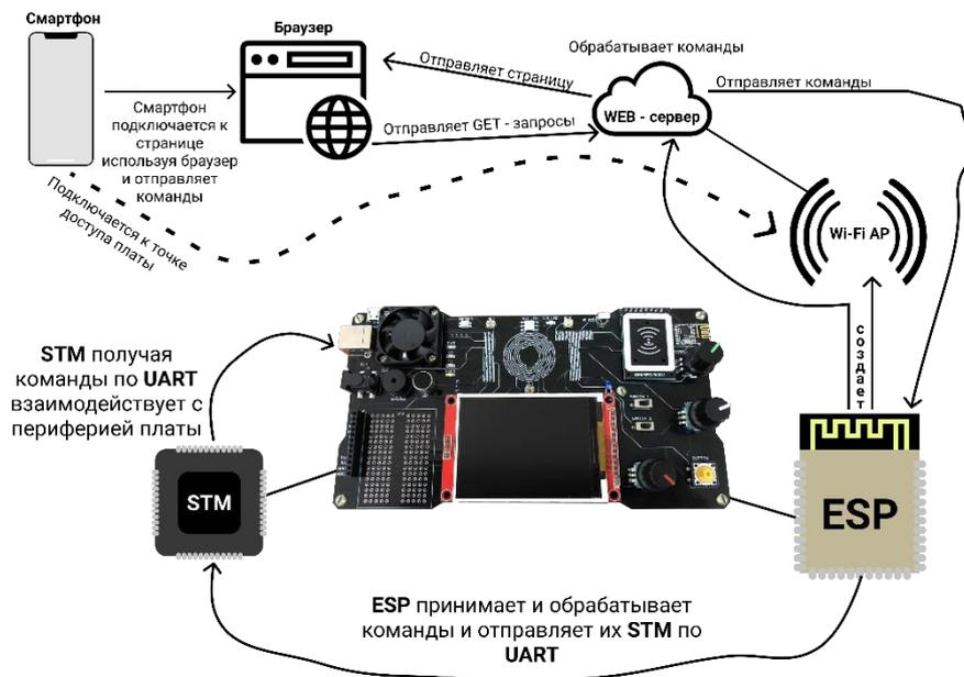
Рисунок 1.1 – Схема подключения
