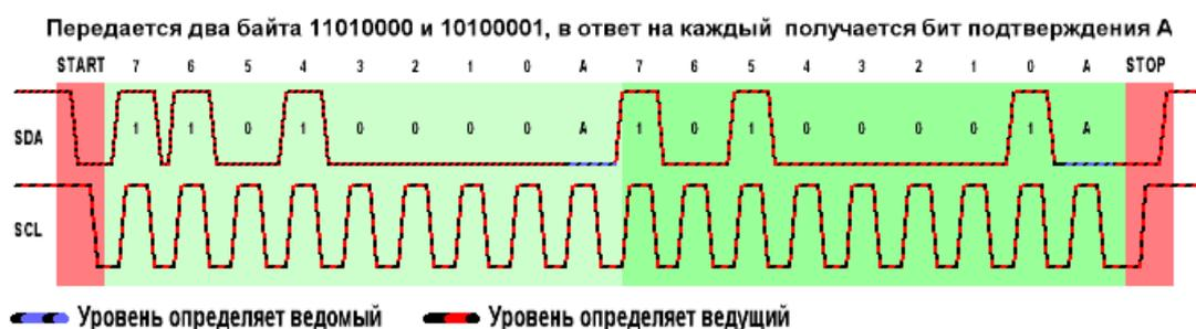
Рисунок 1.3 – Графическое представление передачи двух байт информации
