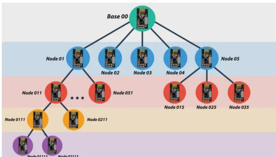
Рисунок 1. 6 – Принцип построения сети с использованием NRF24
