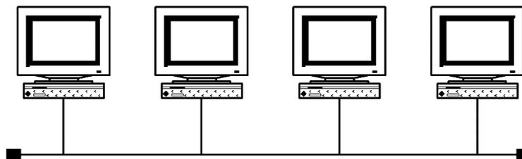
Рисунок 1.1 – Сетевая топология «шина»
