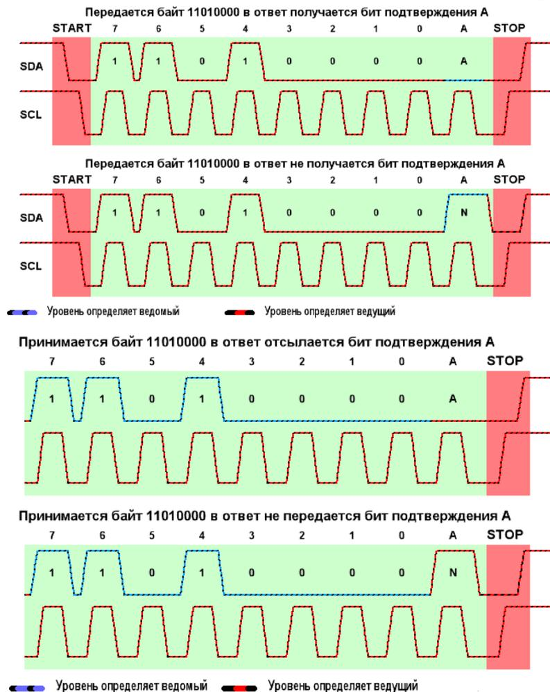
Рисунок 1.2 – Графическое представление передачи данных интерфейса I2C
