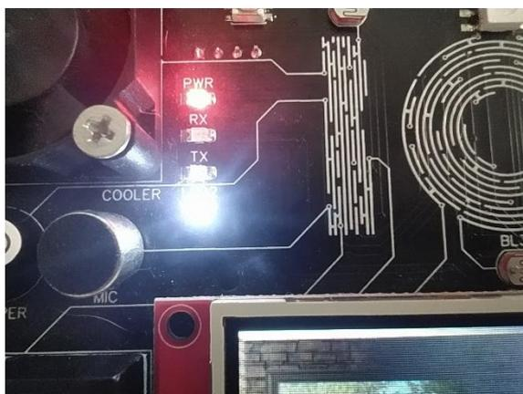
Рисунок 1.4 – Светодиод на плате
