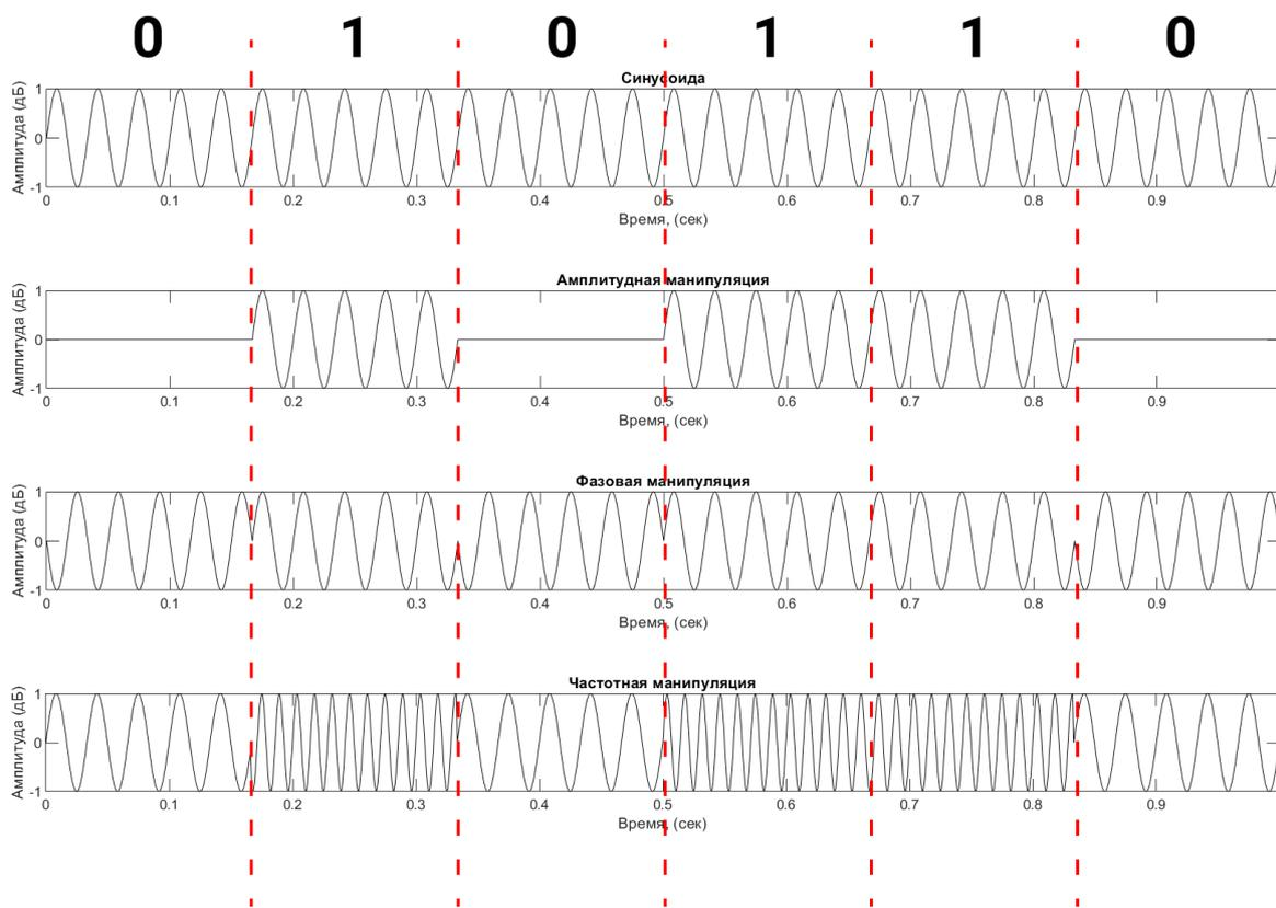
Рисунок 1.2 – Передача данных с использованием разных видов манипуляций
