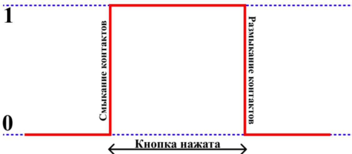
Рисунок 1.4 – Графическое представление изменения сигнала при нажатии на кнопку или переключении свитча
