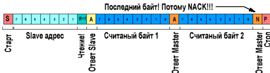
Рисунок 1.7 – Графическое представление следования пакетов данных от ведомого к ведущему в I2C
