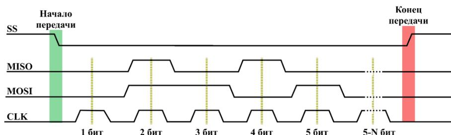
Рисунок 1.5 – Сигнал, передаваемый по интерфейсу SPI
