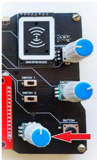
Рисунок 3.2 – Энкодер, используемой для навигации
