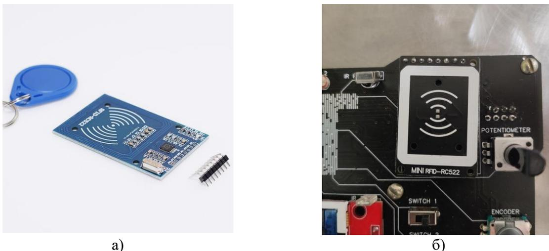
Рисунок 2.1 – Внешний вид RFID-модуля RC522
