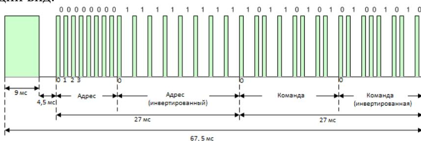
Рисунок 1.2 – Внешний вид пакета стандартной версии протокола NEC
