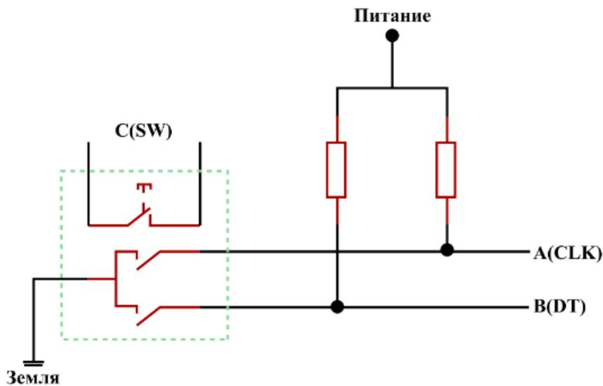
Рисунок 1.6 – Схема датчика угла поворота (энкодера)
