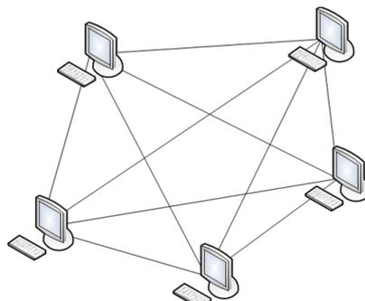
Рисунок 1.4 – ячеистая сетевая топология
