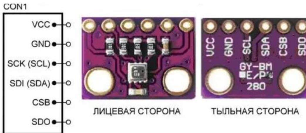
Рисунок 1.2 – Внешний вид модуля BMP280
