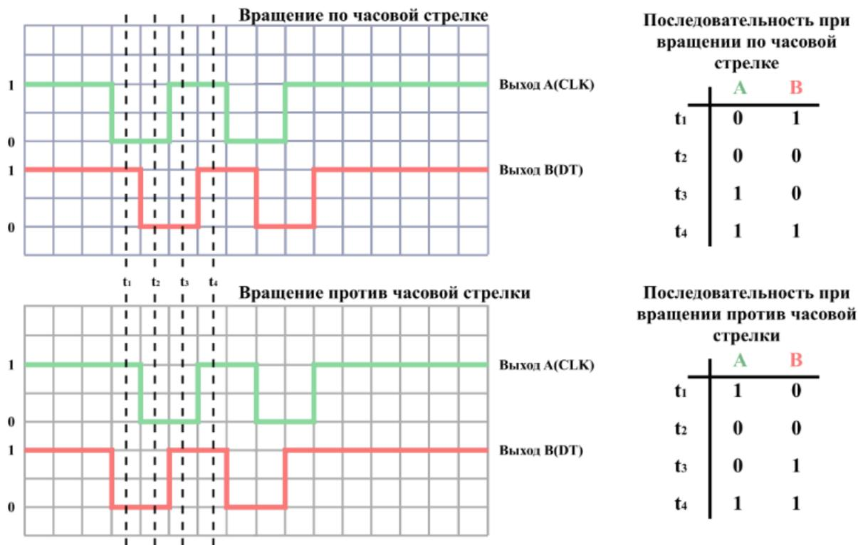
Рисунок 1.7 – Вид сигнала при повороте ручки
