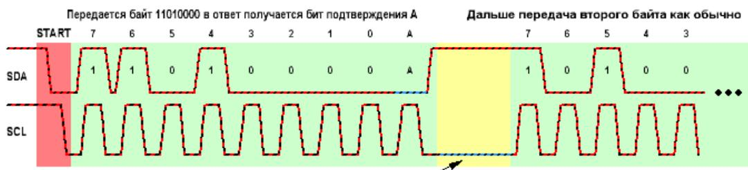
Рисунок 1.4 – Графическое представление принудительного удержания линии SCL Slave(ом)
