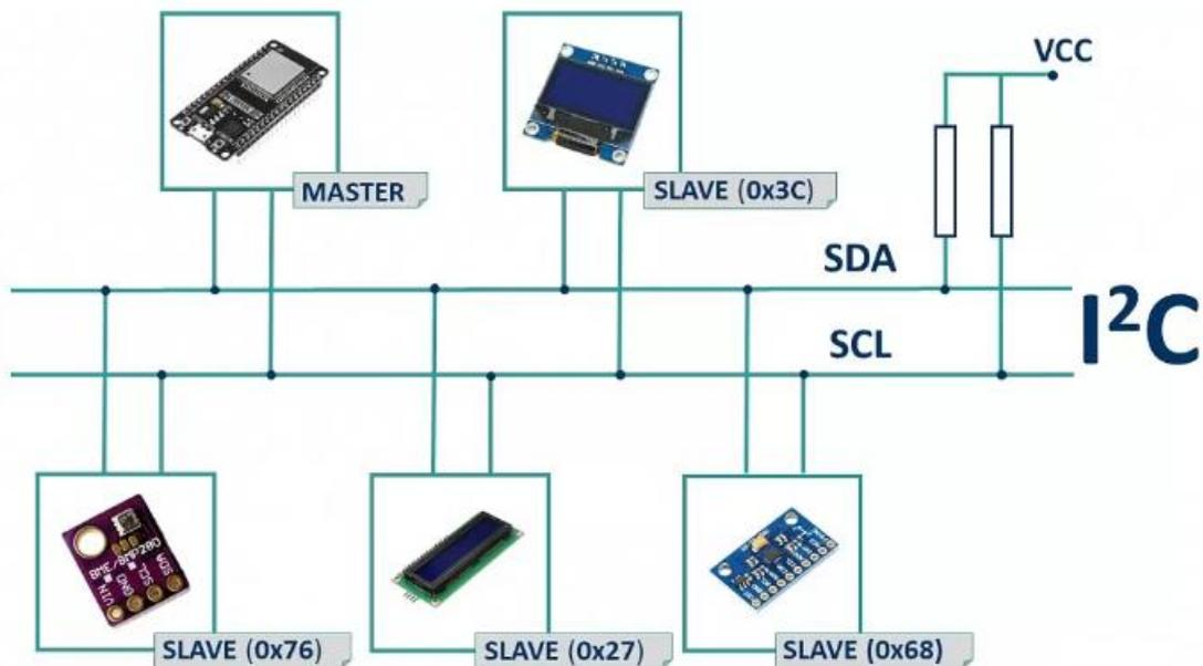
Рисунок 1.1 – Подключение устройств по I2C интерфейсу
