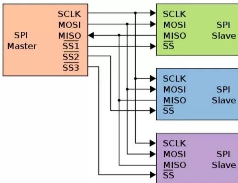
Рисунок 1.2 – Графическое представление второго способа подключения
