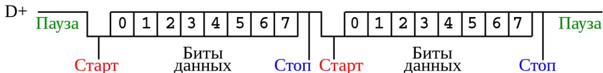
Рисунок 1.1 – Представление пакета данных для передачи по последовательному интерфейсу
