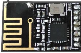
Рисунок 2.1 – Модуль NRF
