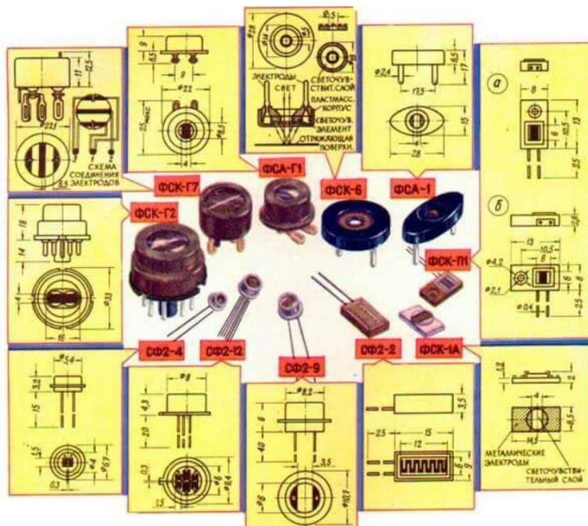
Рисунок 1.1 – Внешний вид фоторезисторов производства СССР
