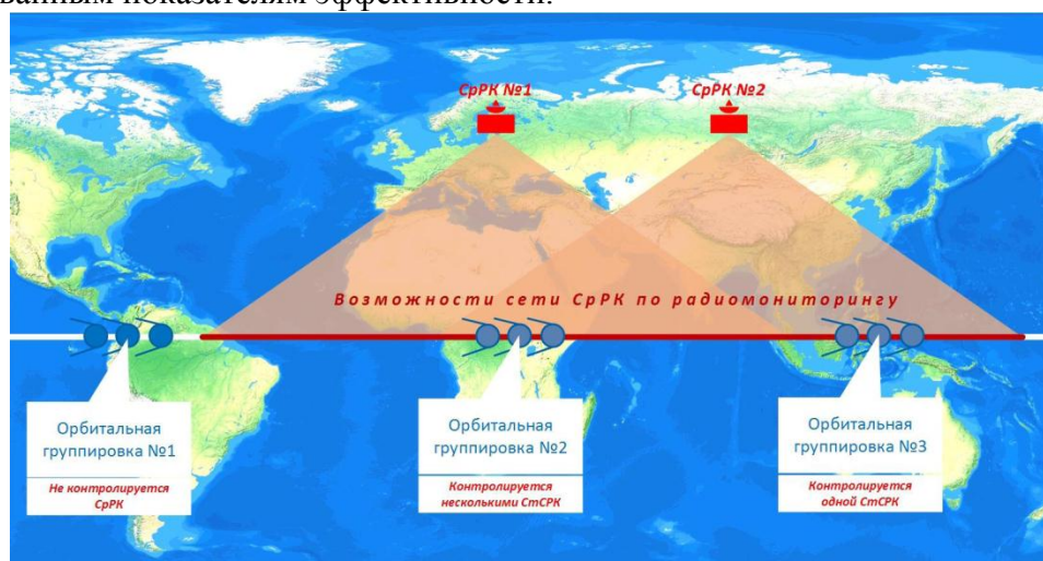
Рис. 3.2 – Варианты радиоконтроля орбитальной группировки КА связи
