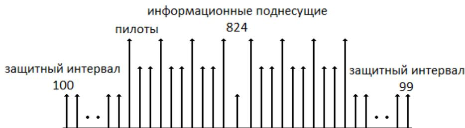
Рисунок 1.1 – Схематичное расположение поднесущих в OFDM символе
