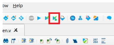
Рисунок 2.14 – Кнопка запуска синтеза
