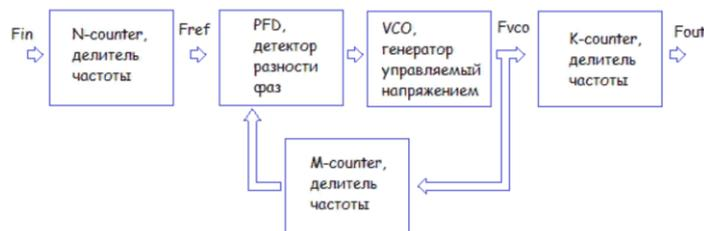
Рисунок 1.1 – Схема работы PLL блока
