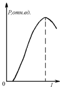
Рисунок 4.6. Зависимость мощности излучения аргонного лазера от плотности разрядного тока
