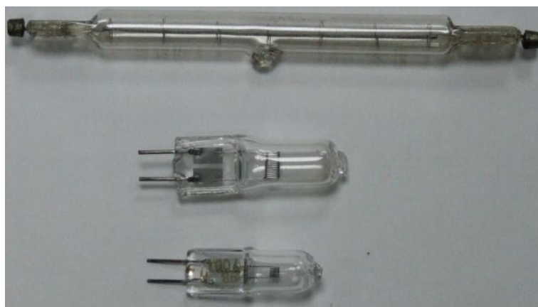
Рисунок 2.7. Внешний вид галогенных ламп, применяемых в спектральных и измерительных оптических приборах
