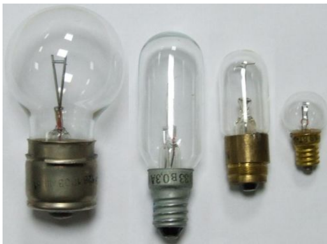
Рисунок 2.6. Внешний вид спектральных ламп накаливания
